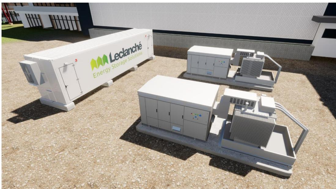
3D-Darstellung der wichtigsten Komponenten für die Installation des Veolia-Gaskraftwerks, darunter (links) das Batterie-Energiespeichersystem und (rechts) zwei Wechselrichter.
